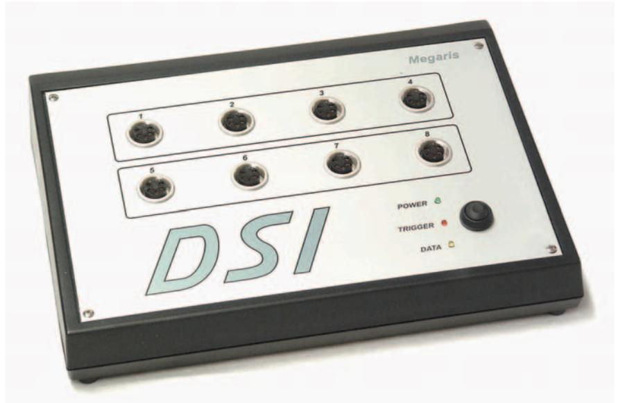
Il controllo della rete RS485 è affidato a un PC. Possono essere collegate in rete fino a 8 centraline, permettendo quindi il condizionamento e l'acquisizione dei dati di un massimo di 64 sensori.
